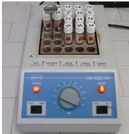
Figura 5.8 - Digestione delle fiale per la misura del COD nel fornello a grafite
