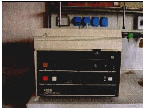
**Fig. 4 Centrifuga CWS – Cool Working System – modello 4235 della A.L.C.**
